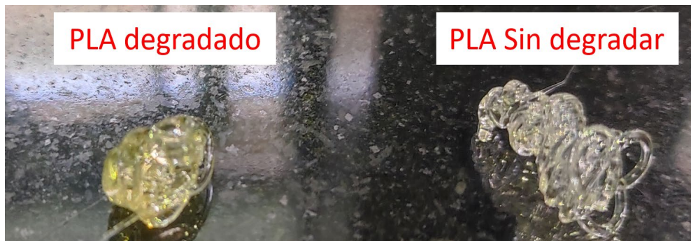
Figura 7.10. Filamentos extruidos con PLA puro a 220 y 190 °C (izquierda y derecha respectivamente) en donde se puede observar la tonalidad amarilla que adquiere el PLA al degradarse térmicamente.
