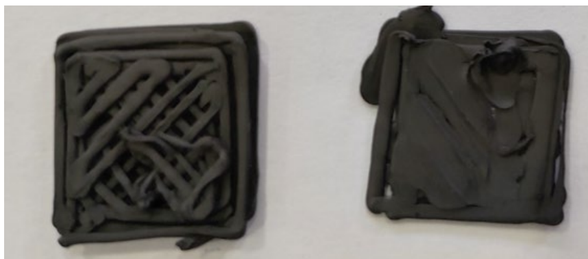
Figura 7.11. Muestras de PLA + 48 % en volumen de WC/Ni impresas con los mismos parámetros de impresión. La muestra de la izquierda presenta un llenado insuficiente mientras que la muestra de la derecha presenta un llenado excesivo debido a un flujo irregular de extrusión.
