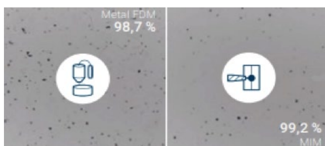
Figura 2.22. Microestructura y porosidad de piezas sinterizadas fabricadas mediante MEAM-HP (metal FDM en esta imagen) y MIM (moldeo por inyección de polvos metálicos) [72].
