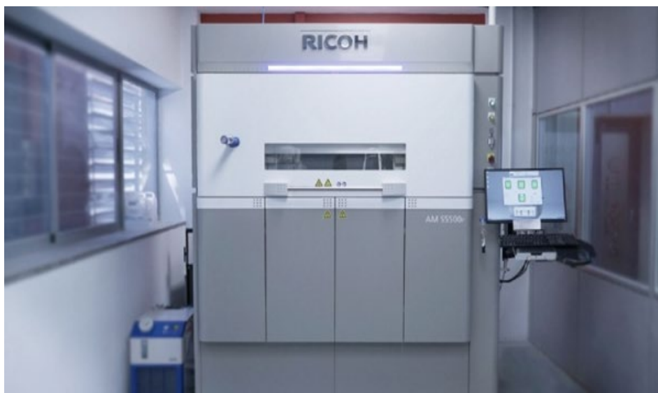
Figura 6.23. Impresora 3D de SLS empleada para la impresión de las diferentes piezas diseñadas y fabricadas en este trabajo [1].
