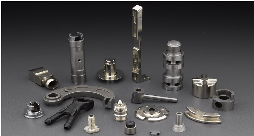
Figura 2.1. Conjunto de piezas fabricadas mediante PIM [12].
